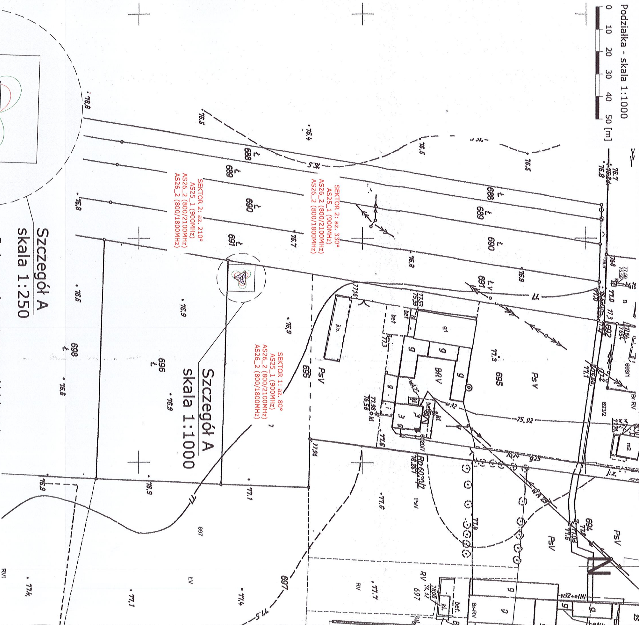
Rys. 4 - Zasięgi występowania promieniowania elektromagnetycznego o wartościach gęstości mocy nie mniejszych niż dopuszczalna wartość, wyznaczone w otoczeniu zespołu anten sektorowych planowanej stacji bazowej telefonii komórkowej P4 Sp. z o.o. - GRD3015A. Skala 1:1000.
